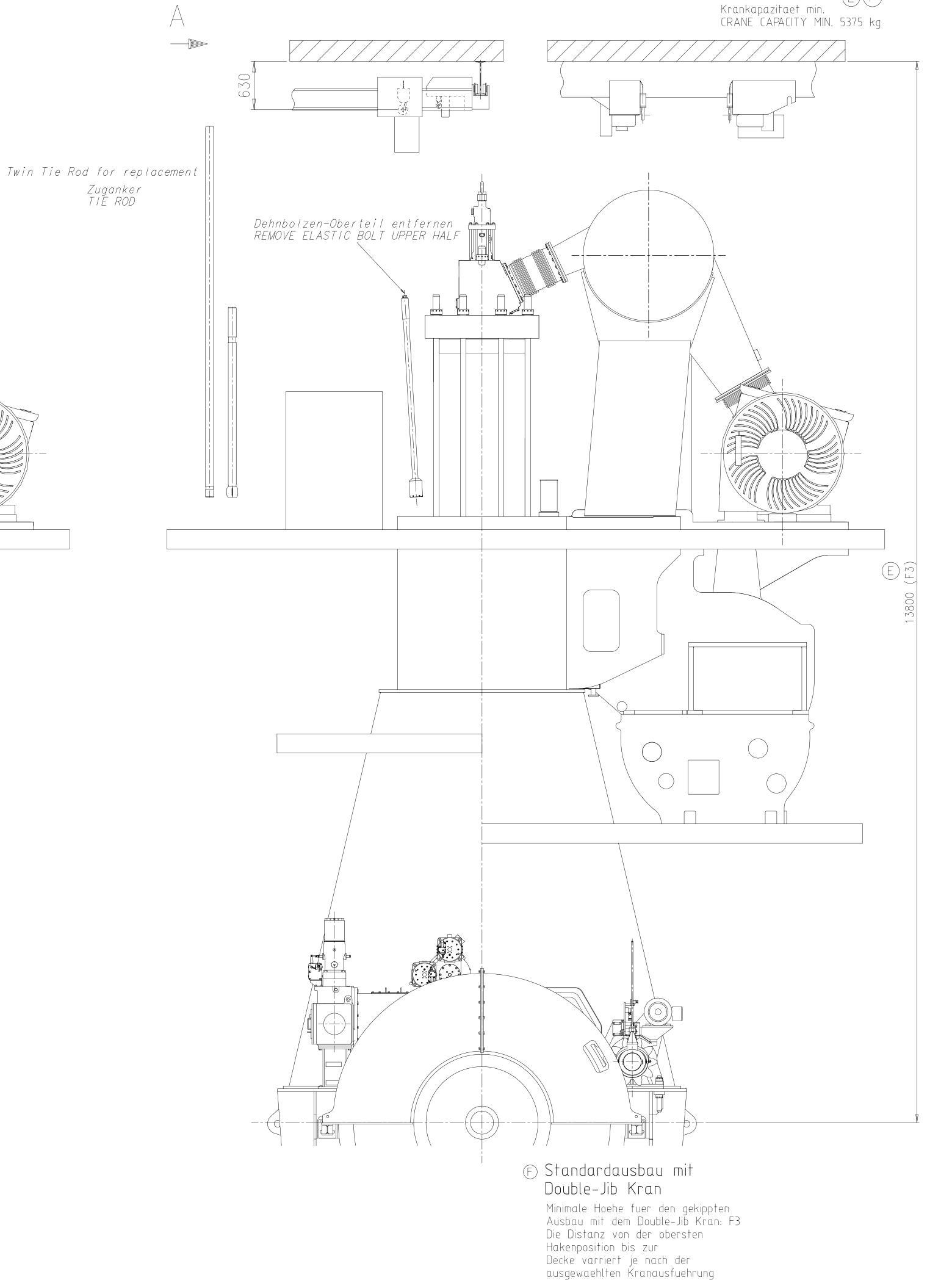
Für gekippten Ausbau mit Double-Jib E/R Kran
