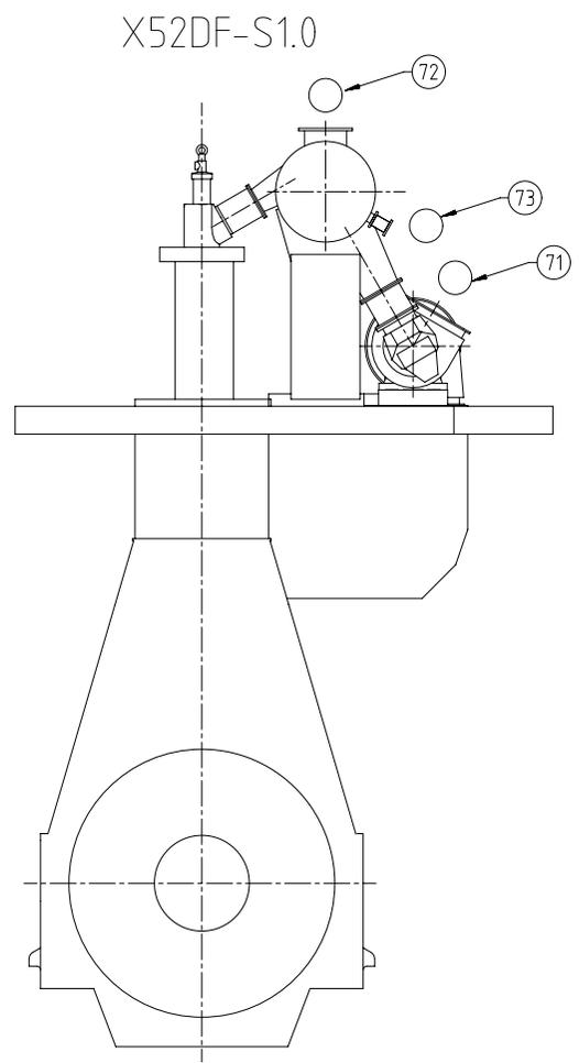
71) OUTLET - Exhaust gas turbocharger
